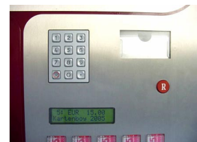
2-zeiliges Display zur Bedienung + vandalismusresistente Telefontastatur
